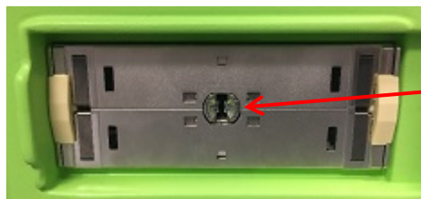
9 pav. Užrakto skylutė keitiklio jungties lizde
